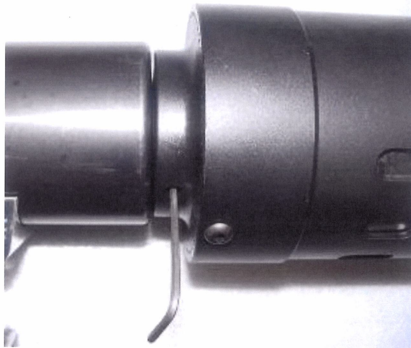
Abb. 20: Festziehen der Mutterschraube des LoadDisc-Antriebs
