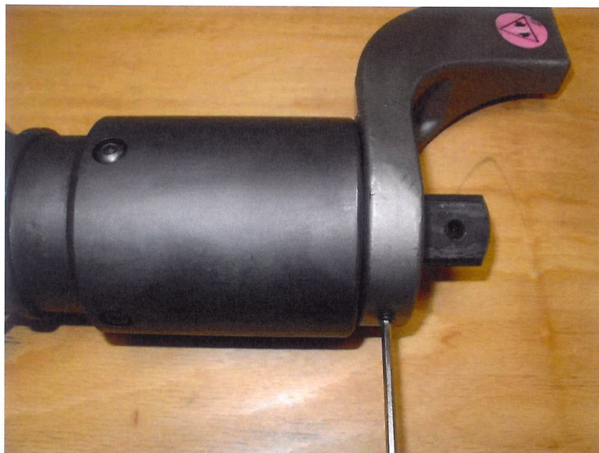
Abb. 6: Halteschraube anziehen und um \frac{1}{4} Umdrehung lösen
