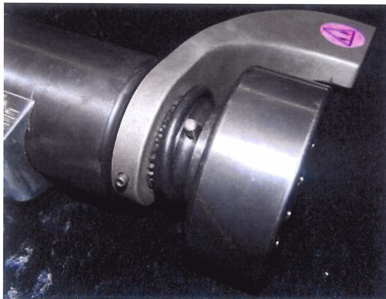
Abb. 8: Einsetzen des Sicherungsstiftes sowie des Halterings
