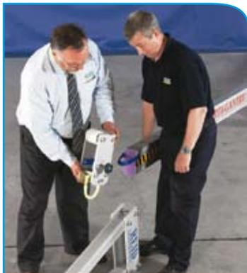
Die Laufkatze über das andere Ende der Lasttraverse einschieben und mit der Reibungsbremse ungefähr mittig zwischen den Rahmen verriegeln.
