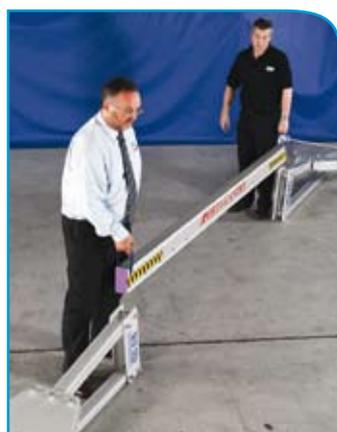
Die zwei Dreiecksrahmen im Abstand einer Lasttraversenlänge voneinander auf einer flachen Oberfläche miteinander fluchtend ablegen, wobei die Laufrollen nach außen zeigen und die Bremsen betätigt sind.
