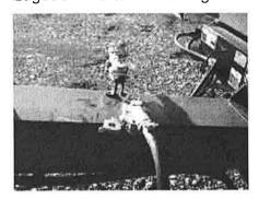
Bild 5: Halterungen Luftanschlüsse
