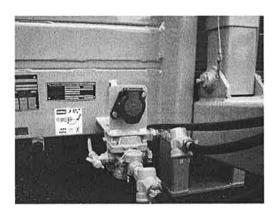
Bild 1: Haltekupplung ABS-Stecker
