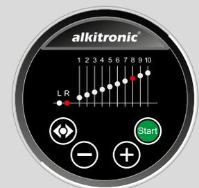
**Bedienoberfläche** zur Anwahl von 19 voreingestellten Abschalt Drehmomenten (inkl. Zwischenpositionen). Ein oder zwei LED zeigen die aktuell ausgewählte Position an.
