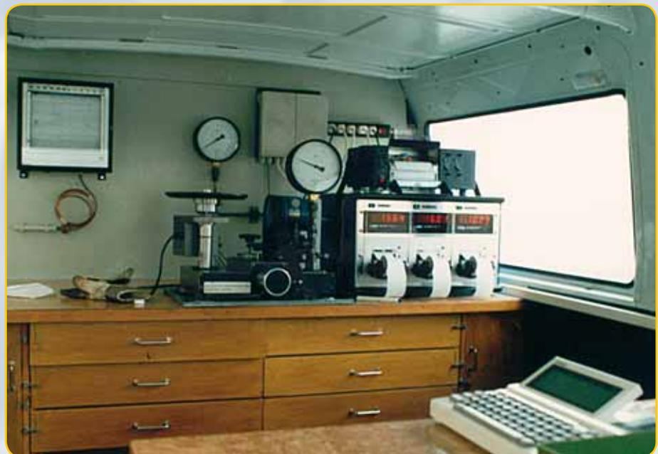
Druckdifferenzmessenrichtung mit Kolbenmanometer, Schreib- und Computereinheit, eingebaut in einen Messwagen.
