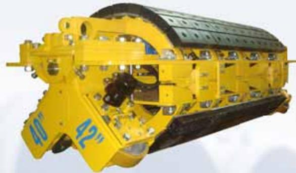
Hydraulisches Wedge-Type-Mandrel 40"-42" (mit Motor)
