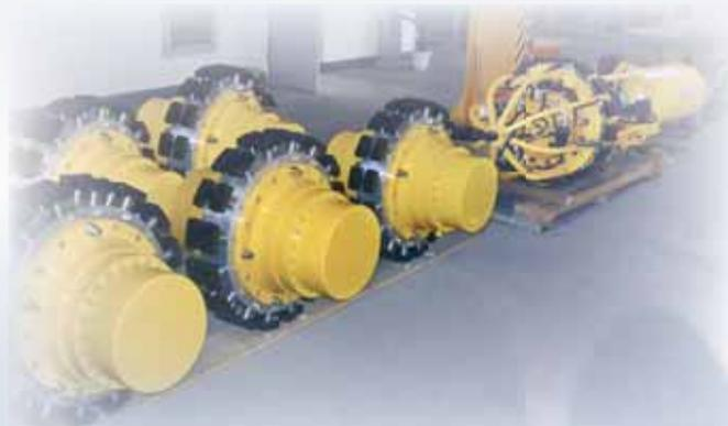
Eine pneumatische Innenzentrierung ist ein feinmechanisches Gerät. Während des Schweißens der Wurzel ist nicht auszuschließen, dass sich Schweißspritzer auf der Innenzentrierung ablagern. Diese müssen mehrmals täglich entfernt werden, um einwandfreies Zentrieren zu ermöglichen. Spätestens nach 10 Stunden Arbeitseinsatz muss die Zentrierung gereinigt, geölt und neu justiert werden.
