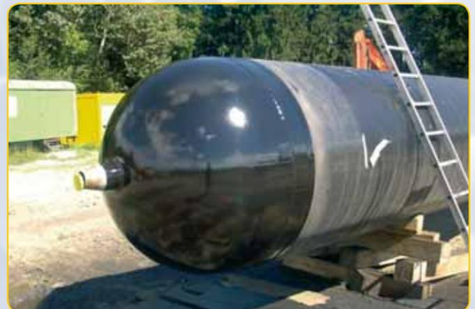
Polyurethan-Heißspritzbeschichtung für die Umhüllung kompliziert geformter Bauteile sowie großer Flächen im Neubau
