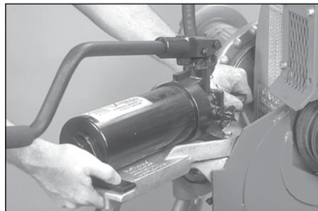
2. Entfernen Sie die Pumpe und die Aufspannfläche an der Seite des Werkzeugs.
