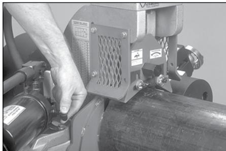
6. Das Druckentlastungsventil an der Pumpe schließen, d.h., im Uhrzeigersinn drehen.
