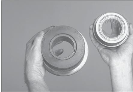
**1.** Stellen Sie sicher, dass der richtige Rollensatz für die Rohrgröße und das Material, die genutet werden sollen, installiert ist. Die Rollen sind mit der Rohrgröße, der Teilenummer sowie in verschiedenen Farben für die einzelnen Rohrmaterialien gekennzeichnet. Siehe dazu „Werkzeugdaten und Rollenauswahl“ auf Seite 28 und 29. Falls das Werkzeug nicht mit den richtigen Rollen ausgestattet ist, siehe „Rollenwechsel“ auf Seite 20.
