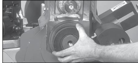
1. Schieben Sie die untere Rolle der gewünschten Größe wie abgebildet mit der markierten Seite ganz nach vorne auf die Hauptwelle. Achten Sie darauf, dass die Rolle ordnungsgemäß mit der Nutfeder an der Hauptwelle ausgerichtet ist. **HINWEIS:** Um das Abnehmen der Rolle zu einem späteren Zeitpunkt zu erleichtern, können Sie eine dünne Schicht Öl oder Schmierfett (Gleitmittel) auf die Hauptwelle auftragen, bevor Sie die untere Rolle installieren.
