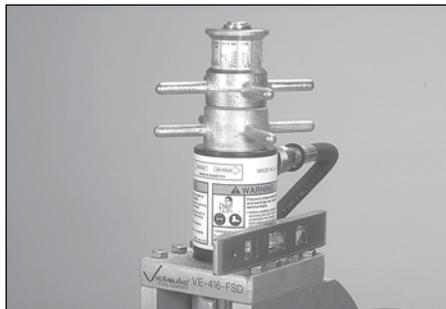
4. Das Werkzeug von vorne nach hinten ausrichten. Die Oberseite des Hydraulikkolbens eignet sich gut zum Messen der Waagrechten.
