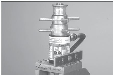
**11.** Das Werkzeug von vorne nach hinten ausrichten. Die Oberseite der Montageplatte für den Zylinder eignet sich gut zum Messen der Waagrechten.
