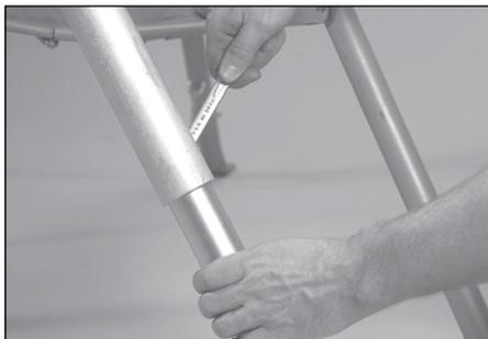
**12.** Lockern Sie die Sechskantschrauben, damit sich die unteren Füße (2) lösen und lassen Sie sie auf den Boden fallen. Drehen Sie die Gummifüße unten, bis sie flach auf dem Boden aufliegen und ziehen Sie die Sechskantschrauben an, wenn das Werkzeug ganz waagrecht ist.
