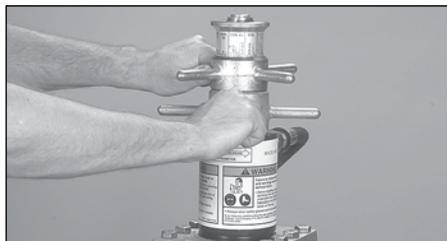
3. Drehen Sie die Tiefeneinstellsperre zurück. Stellen Sie die Tiefeneinstellung wie abgebildet auf den richtigen Durchmesser und Schedule ein. Verriegeln Sie die Tiefeneinstellung mittels der Tiefeneinstellsperre in ihrer Position.
