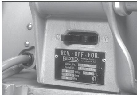
2. Stellen Sie beim Arbeiten mit dem Typ VE416FS den Schalter für den Motorantrieb so ein, dass sich die untere Rolle und das Rohr von der Vorderseite des Werkzeugs aus gesehen **im Uhrzeigersinn** drehen. Wenn der Schalter am Victaulic VPD752 und am Ridgid 300 **in die RÜCKWÄRTS-Stellung** gestellt wird, drehen sich die untere Rolle und das Rohr im Uhrzeigersinn.
