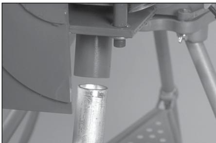
**10.** Stecken Sie die Oberseite der Fußbaugruppe ganz in den Sockel unter dem Werkzeugkopf ein. Drehen Sie die Baugruppe, bis sie fest im Sockel sitzt. Die Sechskantschrauben an den Füßen sollten zur Rückseite des Geräts zeigen (zum Motorantrieb). Ziehen Sie die Sechskantschraube mit einem Schraubenschlüssel an.
