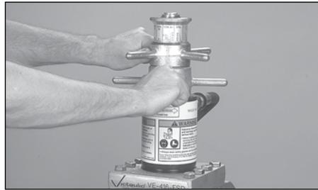
**3.** Den Nutdurchmesser-Anschlag auf Rohrgröße und Schedule/Wandstärke des Rohrs einstellen, das genutet werden soll. Dazu die Tiefenverstellung entriegeln und die Tiefenverstellung mit den richtigen Werten für Durchmesser und Wandstärke einstellen. Die Tiefenverstellung mit der Verriegelung wieder feststellen.
