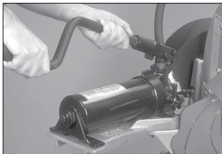
5. Den Griff der Handpumpe in den Hebelarm der Pumpe einsetzen. Den Griff mit dem Handgriff in der untersten Stellung einrichten. Den Handgriff in dieser Position mit der Stellschraube oder der mitgelieferten Mutter und Schraube befestigen.
