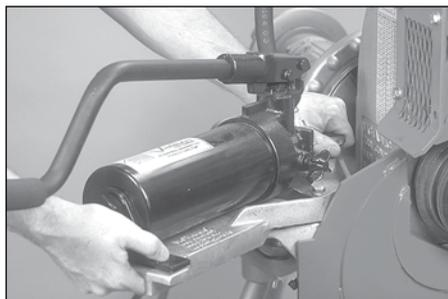
7. Die Pumpe und die Aufspannfläche wieder sicher an der Seite des Werkzeugs befestigen.
