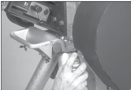
1. Schmieren Sie das Antriebsrad wie abgebildet mit einem Hochleistungsgetriebeöl in Sprayform für hohe Beanspruchung (Lubriplate Gear Shield Extra Heavy oder gleichwertig). Für eine gründliche Schmierung das Werkzeug schließen Sie das Gerät an eine Stromquelle an, und betätigen das Getriebe durch mehrmaliges kurzes Drücken des Fußschalters um das Getriebe an allen Stellen zu schmieren.
