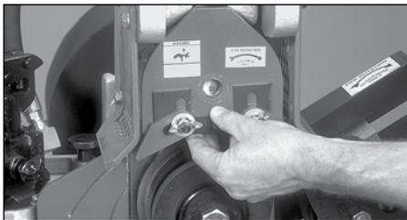
2. Montieren und verschrauben Sie die Halteplatte für die obere Rolle. Richten Sie die Nase an der Platte wie abgebildet mit der Ausparung in der Schiebeplatte aus. Die Schraube mit einem Schraubenschlüssel gut anziehen.
