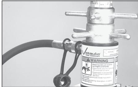
12. Fahren Sie mit dem Nuten solange fort, bis der Tiefenanschlag vollständig mit der Oberseite des Hydraulikzylinders in Berührung ist. Drehen Sie das Rohr noch um eine (1) bis drei (3) Umdrehungen weiter, um sicherzustellen, dass der Nutvorgang abgeschlossen ist.
