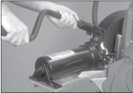
**15.** Den Griff der Handpumpe in den Hebelarm der Pumpe einsetzen. Den Griff mit dem Handgriff in der untersten Stellung einrichten. Den Handgriff in dieser Position mit der Stellschraube oder der mitgelieferten Mutter und Schraube befestigen.
