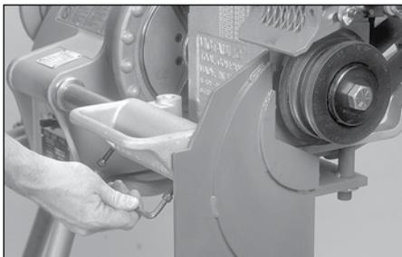
**8.** Ziehen Sie die vier (4) Stellschrauben wie abgebildet an, um das Werkzeug an den Stützarmen zu befestigen.
