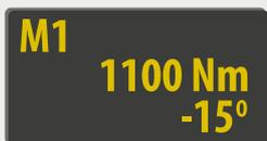
Verschrauben über Drehmoment. Anzeige IST Drehmoment. Automatische Entspannung nach voreingestellten Winkelgraden.
