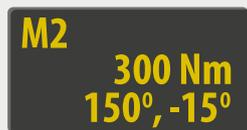
Drehmoment-/Drehwinkelverfahren für Qualitätsverschraubungen. Beispielanzeige von Vordrehmoment, Drehwinkel und Entspannwinkel.
