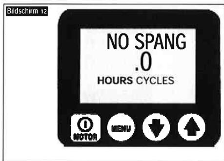
(Siehe Bildschirm 12) Auf diesem Bildschirm kann der Bediener die Anzahl der Stunden ablesen, in denen die Pumpe mit Unterspannung betrieben wurde. Gehen Sie weiter, indem Sie die Menütaste drücken. Siehe QRC Schritt Nr. 5.
