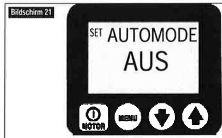
(Siehe Bildschirm 21) Auf diesem Bildschirm kann der Bediener ein- oder ausschalten, ob die Pumpe die Funktionen des Motors/elektrischen Ventils automatisch steuert. Um auf dieses Menü zuzugreifen, gehen Sie zum Menü „EINHEIT“ und halten Sie dann die Taste AN/AUS 7 Sekunden lang gedrückt. Der EINGABE CODE wird angezeigt. Halten Sie dann die AN/AUS- und Pfeil-nach-oben-Taste 7 Sekunden lang gedrückt.
