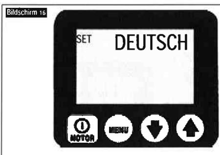
Wenn eine Sprache auf der Textanzeige angezeigt wird, kann der Bediener die Anzeigesprache einstellen, indem er die Pfeil-nach-unten- oder Pfeil-nach-oben-Taste drückt. Speichern Sie die Einstellung und gehen Sie weiter, indem Sie die Menütaste drücken. Siehe QRC Schritt Nr. 9.
