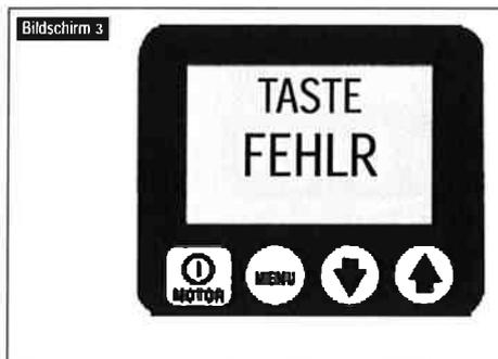
„Tastefehl“ wird angezeigt, wenn der Mikroprozessor einen Tastendruck während der Startsequenz erkennt oder wenn die Ein/Aus-Taste am Gehäuse mehr als 3 Sekunden lang gedrückt wird.
