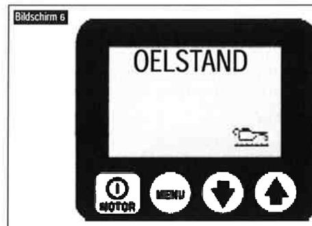
Der "Ölstand" Fehler wird angezeigt, wenn der Ölpegel im Behälter unterhalb von 34 mm vom Boden aus gesehen sinkt.
