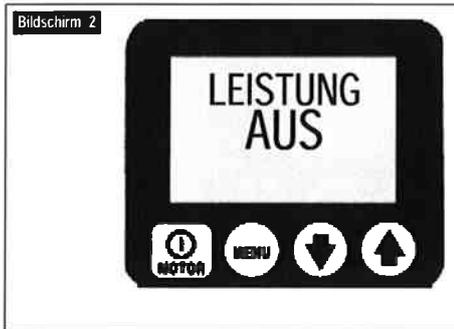
Der Fehler "Leistung Aus" wird angezeigt, wenn die Netzstromversorgung auf 65% oder weniger der Nennspannung sinkt. Die Pumpe schaltet automatisch die Ventile und den Motor aus und zeigt "Leistung Aus" auf dem LCD an. HINWEIS: (Leistung Aus wird auch einige Sekunden lang angezeigt, wenn das Gerät vom elektrischen Strom getrennt wird.)
