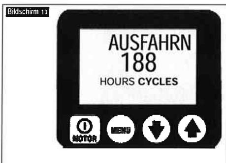
(Siehe Bildschirm 13) Auf diesem Bildschirm kann der Bediener die Anzahl der Stunden (Ein/Aus-Zyklen) ablesen, in denen das Vorlaufmagnetventil betrieben wurde. Schalten Sie zwischen Stunden und Zyklen um, indem Sie die Pfeil-nach-oben- oder Pfeil-nach-unten-Taste drücken. Gehen Sie weiter, indem Sie die Menütaste drücken. Siehe QRC Schritt Nr. 6.
