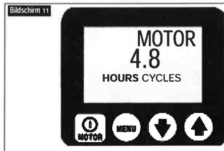
(Siehe Bildschirm 11) Auf diesem Bildschirm kann der Bediener die Anzahl der Stunden (Ein/Aus-Zyklen) ablesen, in denen der Motor betrieben wurde. Schalten Sie zwischen Stunden und Zyklen um, indem Sie die Pfeil-nach-oben- oder Pfeil-nach-unten-Taste drücken. Gehen Sie weiter, indem Sie die Menütaete drücken. Siehe QRC Schritt Nr. 4.
