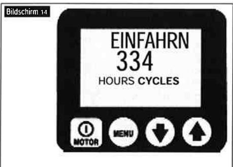
(Siehe Bildschirm 14) Auf diesem Bildschirm kann der Bediener die Anzahl der Stunden (Ein/Aus-Zyklen) ablesen, in denen das Rücklaufmagnetventil betrieben wurde. Schalten Sie zwischen Stunden und Zyklen um, indem Sie die Pfeil-nach-oben- oder Pfeil-nach-unten-Taste drücken. Gehen Sie weiter, indem Sie die Menütaste drücken. Siehe QRC Schritt Nr. 7.
