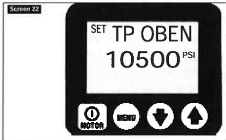
(Siehe Bildschirm 22) Auf diesem Bildschirm kann der Bediener die Hochdruckgrenze für die Pumpe zum Ausschalten des Motors/elektrischen Ventils einstellen (Ähnlich der Funktion „SET DRUK“ bei Firmware 5.5 und früher): Maximalwert ist 10.500 psi (724 bar).
