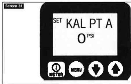
(Siehe Bildschirm 24) Auf diesem Bildschirm kann der Bediener den auf dem LCD angezeigten Druckwert einstellen, so dass er zu einem Mastermessgerät passt. So greifen Sie auf dieses Menü zu:
