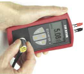
Bild 5: Kalibrieren auf dem eingebauten 5-mm-Kalibriermittelblock
