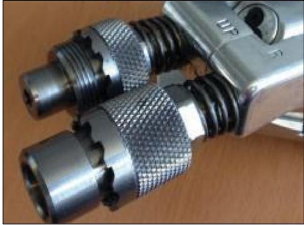
b) Die Verbindungen am Scharnier des Hydraulikschraubers dürfen NICHT eloxiert sein!
