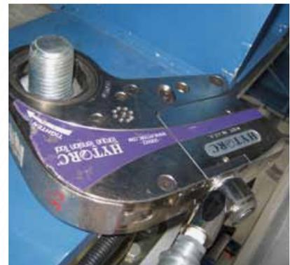
Folglich ist nur eine Drehmomenttabelle von der kleinsten bis zur größten Standard-Schlüsselweite innerhalb eines Modells aus der Baureihe HYTORC Stealth nötig.
