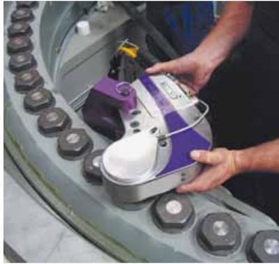
ist darüber hinaus noch mit einem automatischen Dual-Kolbensystem ausgerüstet, welches die Schraubgeschwindigkeit markant erhöht. Befindet sich das Werkzeug im niedrigen Drehmomentbereich, arbeitet lediglich eines der beiden Kolbensysteme. Das hohe Fördervolumen der
