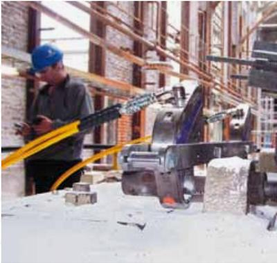
HYTORC Stealth – Das neue, zukunftsweisende hydraulische Ringschlüsselwerkzeug mit superflachen Ringschlüsselkassetten, mit kleinsten Kopfradien und trotzdem hohen Drehmomenten. Das Antriebssystem besitzt die gleiche Bauhöhe wie die Ringschlüsselkassetten und
