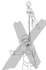
Ne pas faire de nœuds dans de la chaîne de charge ou la connecter à l'aide de chevilles, boulons, tournevis ou similaire. Ne pas réparer les chaînes installées dans le palan.
