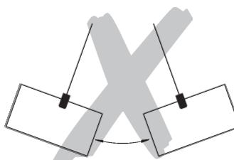
De last mag niet in een omgeving verplaatst worden die voor de gebruiker niet zichtbaar is.
