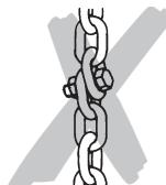
Das Entfernen der Sicherheitsbügel von Trag- bzw. Lsthaken ist verboten.
