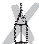
Ein ohne Rücksprache mit dem Hersteller verändertes Gerät darf nicht benutzt werden.
