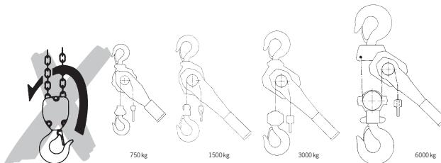
Plaats alleen kettingen die toegelaten zijn door de fabrikant. Het niet respecteren van deze specificaties zal tot gevolg hebben dat de garantie met onmiddellijke ingang vervalt.
