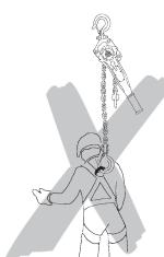
Yük zinciri civata, vida, tornavida vb. ile bağlanamaz. Kaldırma ekipmanlarına sabit monte edilmiş olan yük zincirleri onarılamaz.
