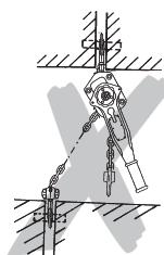
La chaîne de charge ne doit pas être utilisée comme élingue.
