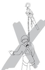
Maak geen knopen in de lastketting. De lastketting niet met bouten, schroeven, schroevendraaiers of iets dergelijks met elkaar verbinden. Lastkettingen die in de takel ingebouwd zijn mogen niet gerepareerd worden.
