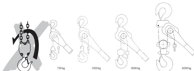
Csak a gyártó által engedélyezett teherláncot szereljenek fel. Ennek az előírásnak a be nem tartása a jótállás vagy garancia azonnali elvesztésével jár.
