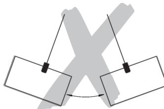
La charge ne doit pas être déplacée dans des zones qui ne sont pas visibles par l'opérateur.
