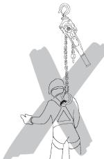
Грузовую цепь не следует завязывать узлом или соединять с помощью чеки, болта, отвертки и т. п. Цепи, вмонтированные в грузоподъемное устройство, ремонту не подлежат.
