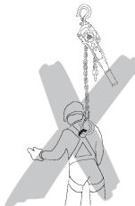
Łańcucha ładunkowego nie zawężać i nie łączyć przy użyciu sworzni, śrub, wkrętaków i tym podobnych. Łańcuchy ładunkowe zamontowane na stałe w dźwignicach nie mogą być naprawiane.
