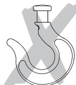
Ne jamais attacher la charge sur la pointe du crochet. L'accessoire de levage doit toujours être positionné dans le fond du crochet.
