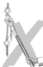
L'appareil de doit jamais être utilisé avec plus de puissance que celle d'une personne.
