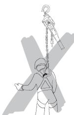
Ne csomózzák össze a teherláncot. A teherláncot ne kapcsolják össze csapszegek, csavarok, csavarhúzók vagy hasonlók használatával. A teherláncokon ne hajtsanak végre javítást, amikor azok be vannak építve az emelőszerkezetbe.
