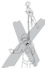
La cadena de carga no se puede atar o sujetar con tuercas, tornillos, destornilladores o similares. Las cadenas de carga montadas firmemente en el elevador no deben ser reparadas.
