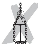
A gyártó megkérdezése nélkül módosított egységet tilos használni.
