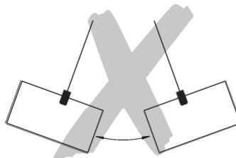
Die Last darf nicht in Bereiche bewegt werden, die für den Bediener nicht einsehbar sind.
