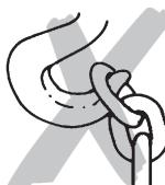
Zincir uç parçası normal kaldırma sınırlandırması için kullanılamaz.
