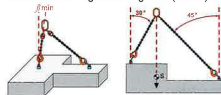
Stränge nicht mehr als 15° voneinander abweichen und die Winkel der Anschlagpunkte in der Anschlagenebene (von oben betrachtet), also die Winkel  $\alpha_1$ ,  $\alpha_2$  und  $\alpha_3$  bei einem dreisträngigen Gehänge und die Winkel  $\alpha_1$  zu  $\alpha_2$  und getrennt betrachtet die Winkel  $\alpha_3$  zu  $\alpha_4$  bei einem vier-strängigen Gehänge\* um nicht mehr als 15° voneinander abweichen.
