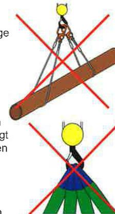
Der Hängegang, bei dem zwei Anschlagmittel unter der Last durchgeschoben werden und am Kranhaken dann vier oder mehr Ösen bzw. Schlaufen befestigt werden, ist zu vermeiden, wenn der Kranhaken die Schlaufen nicht aufnehmen kann, bzw. diese übereinander liegen (Quetschungen).
