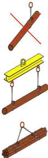
Bei größeren Neigungswinkeln und/oder rutschigen Oberflächen der Last besteht die Gefahr des Zusammenrutschens der Anschlagmittel durch die hohen Querkräfte. Dies würde Instabilität und die Gefahr des Herausrutschens der Last bedeuten. In diesen Fällen unbedingt den Winkel durch Verwendung von Lasttraversen gering halten!
