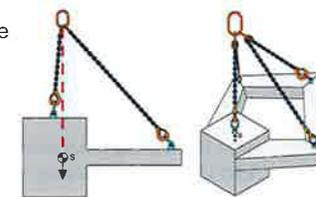
Wenn im Fall von mehrsträngigen Anschlagmitteln die Anschlagpunkte nicht symmetrisch verteilt sind, darf ebenfalls nicht von der vollen Tragfähigkeit ausgegangen werden, da sich die Last ungleich auf die einzelnen Stränge verteilt.
