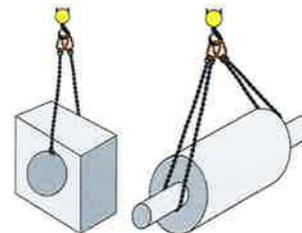
Im Hängegang wird das Anschlagmittel entweder durch eine Öffnung der Last hindurchgeführt und beide Ösen bzw. Schlaufen im Kranhaken direkt eingehängt oder ein Verrutschen der Anschlagmittel oder der Last ist aufgrund der Formgebung der Ladung nicht möglich.
