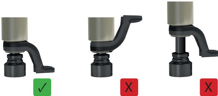
Das Gerät nicht schräg auf Schraubverbindung aufsetzen, beispielsweise bei beengten Platzverhältnissen. Es besteht Quetschgefahr, die Kraftnuss kann platzen oder das Gerät kann beschädigt werden.
