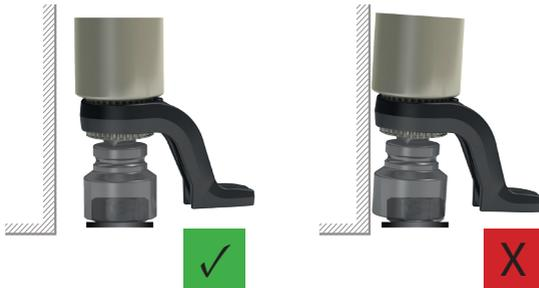
1. Stecken Sie die Kraftnuss (L) auf den Antriebsvierkant (K). Achten Sie darauf, dass die Bohrung der Kraftnuss (L) mit der Bohrung des Antriebsvierkants (K) übereinstimmen, damit die Impactfix-Funktion greift bzw. der Kraftnuss-Stift (V) eingeführt werden kann
