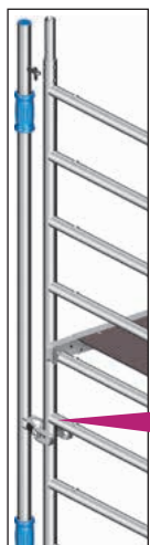
Bild 4: Anschluss Montagepfosten an der Standleiter
