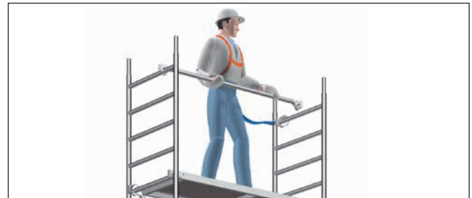
Bild 3: Sichere Montage des Geländers mit PSA
