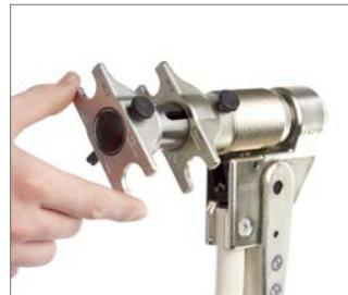
4. Eseguire sempre il cambio delle teste a forcetta nella posizione di partenza (leva in massima apertura).
