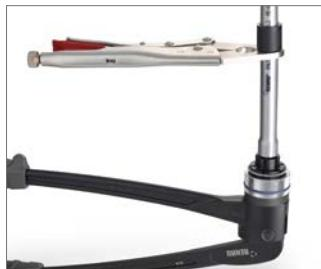
2. Durch Drehen des Werkzeugzylinders können die Verpressjoch in die richtige Arbeitsposition gebracht werden.
