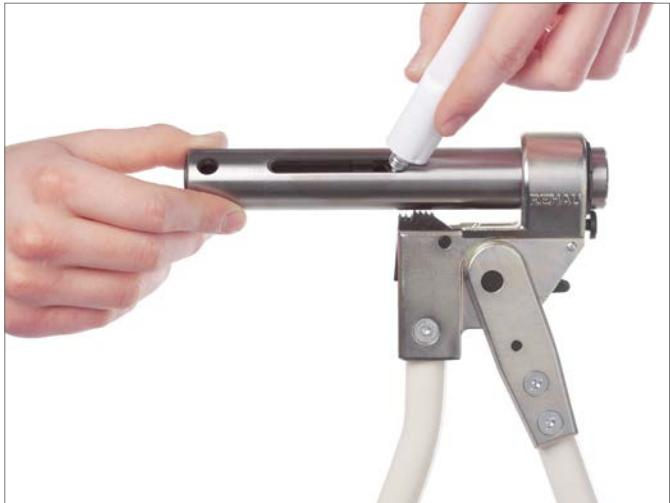
Ingrassare regolarmente l'interno del cilindro (tubetto di lubrificante in dotazione), mantenendo asciutta la superficie esterna del cilindro. Non ingassare la testa a forcella.
