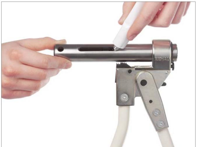
Zylinder innen regelmäßig einfetten (Tube Schmiermittel liegt bei), dabei Zylinderaußenfläche trockenhalten. Verpressjoche werden nicht eingefettet.
