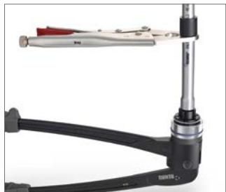
3. Mettre les mors dans la position de travail correcte en tournant le cylindre de compression.
