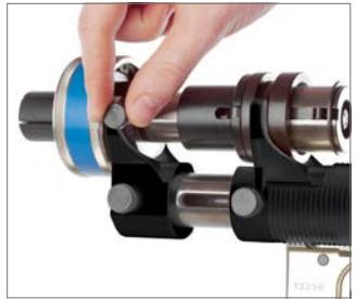
Vor Inbetriebnahme des Werkzeuges müssen der korrekte Sitz (vollständig in den Jochen) und die Klemmwirkung des Aufweitgerätes in den Jochen überprüft werden (Vermeidung des Herausfallens!).
