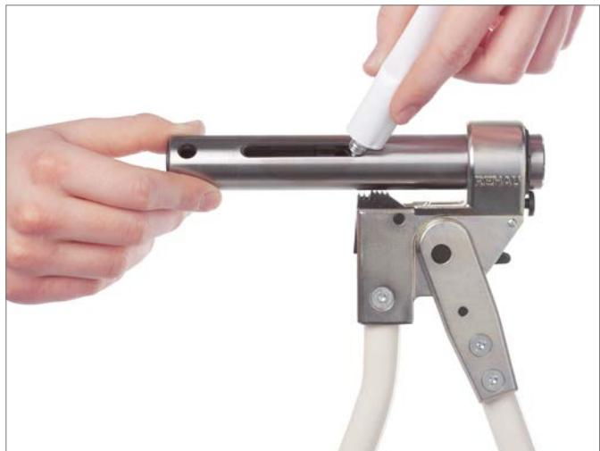
Lubrifier régulièrement l'intérieur du cylindre (tube de lubrifiant fourni) tout en veillant à ce que la surface extérieure du cylindre reste sèche. Ne pas lubrifier les mors.
