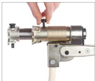
La **pince-étau** est utilisée pour maintenir la bague à sertir sur un tube vertical. La pince-étau sert également à maintenir vers l'arrière l'isolation ou le tube annelé pour créer l'espace nécessaire à la réalisation de raccordements.
