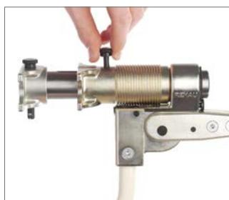
Mit der **Rohrgripzange** kann die Schiebehülse beim Herstellen von vertikal verlaufenden Leitungen gehalten werden. Die Rohrgripzange dient auch dazu, um Isolierung oder Wellrohr zurückzuschieben und festzuhalten, um den nötigen Platz zum Herstellen der Schiebehülsenverbindungen zu schaffen.
