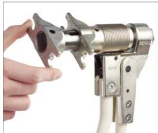
3. Anschließend kurzen Steckstift in das lange Joch und langen Steckstift in das kurze Joch vollständig einstecken.
