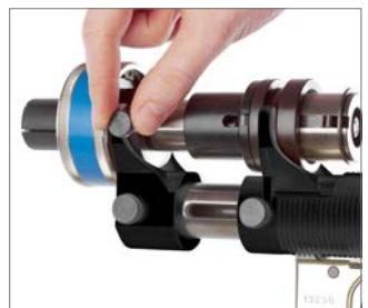
Avant l'utilisation de l'outil, vérifier son bon positionnement (insertion totale dans les mors) et le bon serrage de la tête d'expansion hydraulique dans les mors (pour éviter une chute de la tête !).
