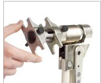
4. Verpressjochwechsel immer in Ausgangsposition (Werkzeughebel in max. Auslegung) durchführen.
