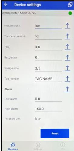
Einstellung der Manometer/Logger Eigenschaften über "Device settings" Aktivierung des Wahlmenü's über "Pfeil nach oben" Taste
