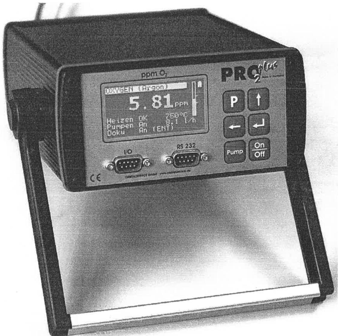
Sauerstoffmessgerät für inerte und reaktive Gase
