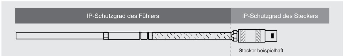
■ Ausführung mit Stecker, an der MI-Leitung montiert
