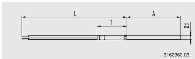
Anschlusskabel mit CrNi-Stahl-Schutzgewebe
