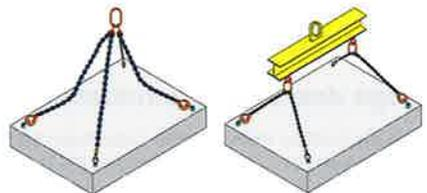
Wenn im Fall von mehrsträngigen Anschlagmitteln die Einzelstränge unterschiedliche Neigungswinkel aufweisen, tritt die größte Beanspruchung in dem Einzelstrang mit dem kleinsten Neigungswinkel auf.
