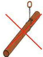
Bei größeren Neigungswinkeln und/oder rutschigen Oberflächen der Last besteht die Gefahr des Zusammenrutschens der Anschlagmittel durch die hohen Querkräfte. Dies würde Instabilität und die Gefahr des Herausrutschens der Last bedeuten. In diesen Fällen unbedingt den Winkel durch Verwendung von Lasttraversen gering halten!
