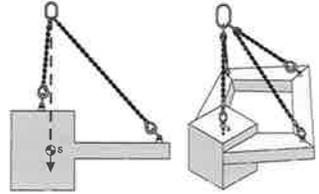
Wenn im Fall von mehrsträngigen Anschlagmitteln die Anschlagpunkte nicht symmetrisch verteilt sind, darf ebenfalls nicht von der vollen Tragfähigkeit ausgegangen werden, da sich die Last ungleich auf die einzelnen Stränge verteilt.
