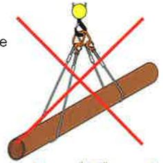
Der Hängegang, bei dem zwei Anschlagmittel unter der Last durchgeschoben werden und am Kranhaken dann vier oder mehr Ösen bzw. Schlaufen befestigt werden, ist zu vermeiden, wenn der Kranhaken die Schlaufen nicht aufnehmen kann, bzw. diese übereinander liegen (Quetschungen).
